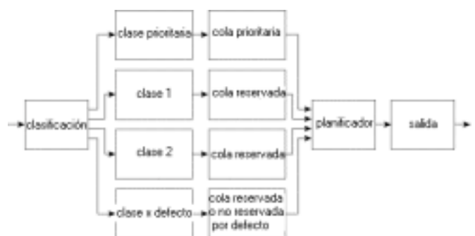
Figura 6. Funcionamiento del encolamiento LLQ
